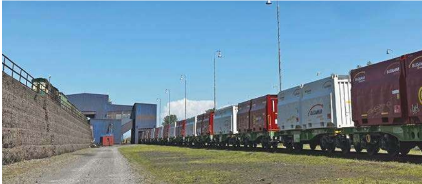
Špeciálne vozne typu Sggmmrrs s kontajnerovými nadstavbami pristavené na nakládku na pracovisku Prekladkovy komplex Východ.
