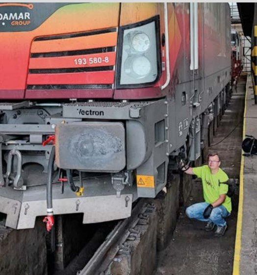
Technik Martin Gurčík pri kontrole zabezpečovacieho systému SHP na hnacom koľajovom vozidle Vectron 193 580-8.
