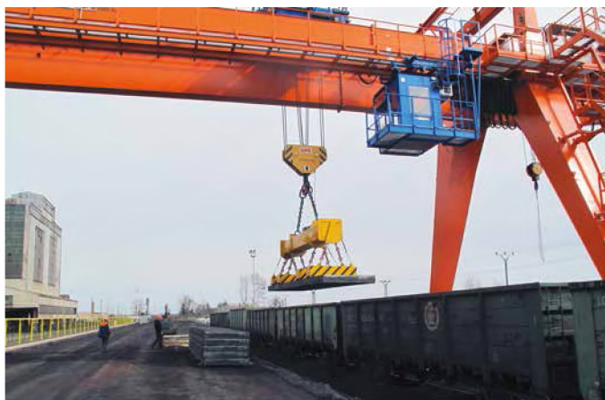
Prekládka brám na pracovisku Východná rampa – Portál. Transshipment of steel slabs at the East Ramp – Gantry Crane workplace.
